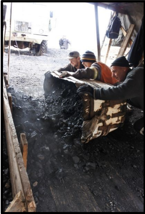
Fig. 36. Operazioni di superficie: dopo aver svuotato la vasca da bagno, i minatori passano al setaccio (ricavato dalla rete di un letto) il carbone appena estratto.
