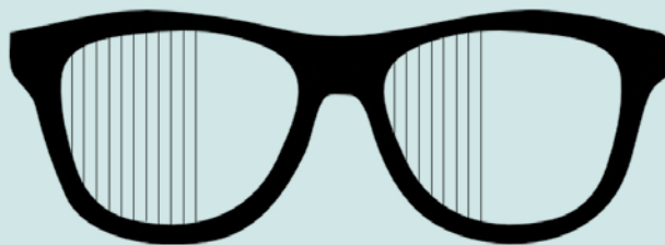
Figura 3 Schema di applicazione su di un occhiale di prismi di Fresnel parziali binoculari.
