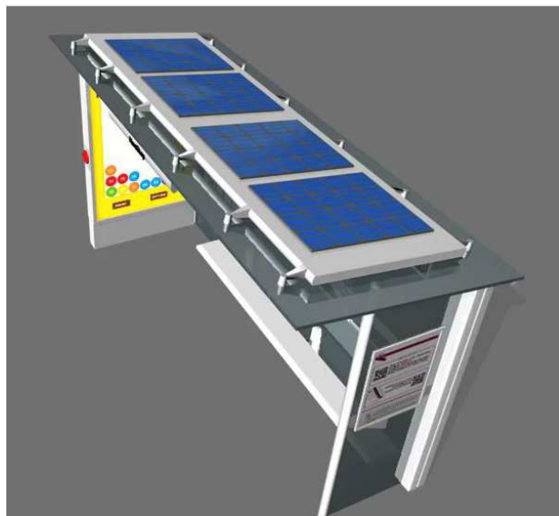
Figura 39 Dettaglio pannelli solari per l'alimentazione dei servizi della pensilina.
