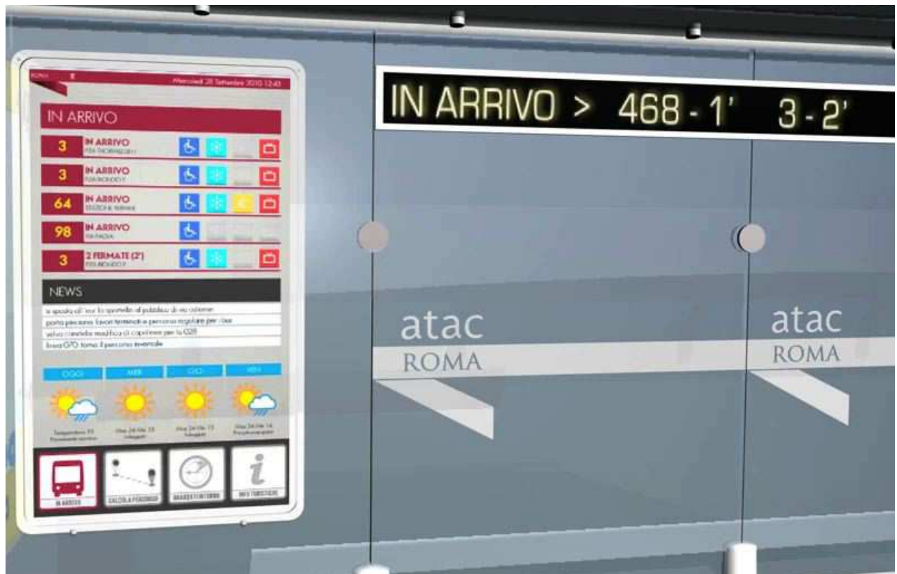
Figura 35 - Dettaglio interfacce per la visualizzazione delle informazioni. A sinistra è presente uno schermo touch per informazioni interattive. Nella parte alta è presente un display ad alta luminosità per le informazioni sempre visibili.
