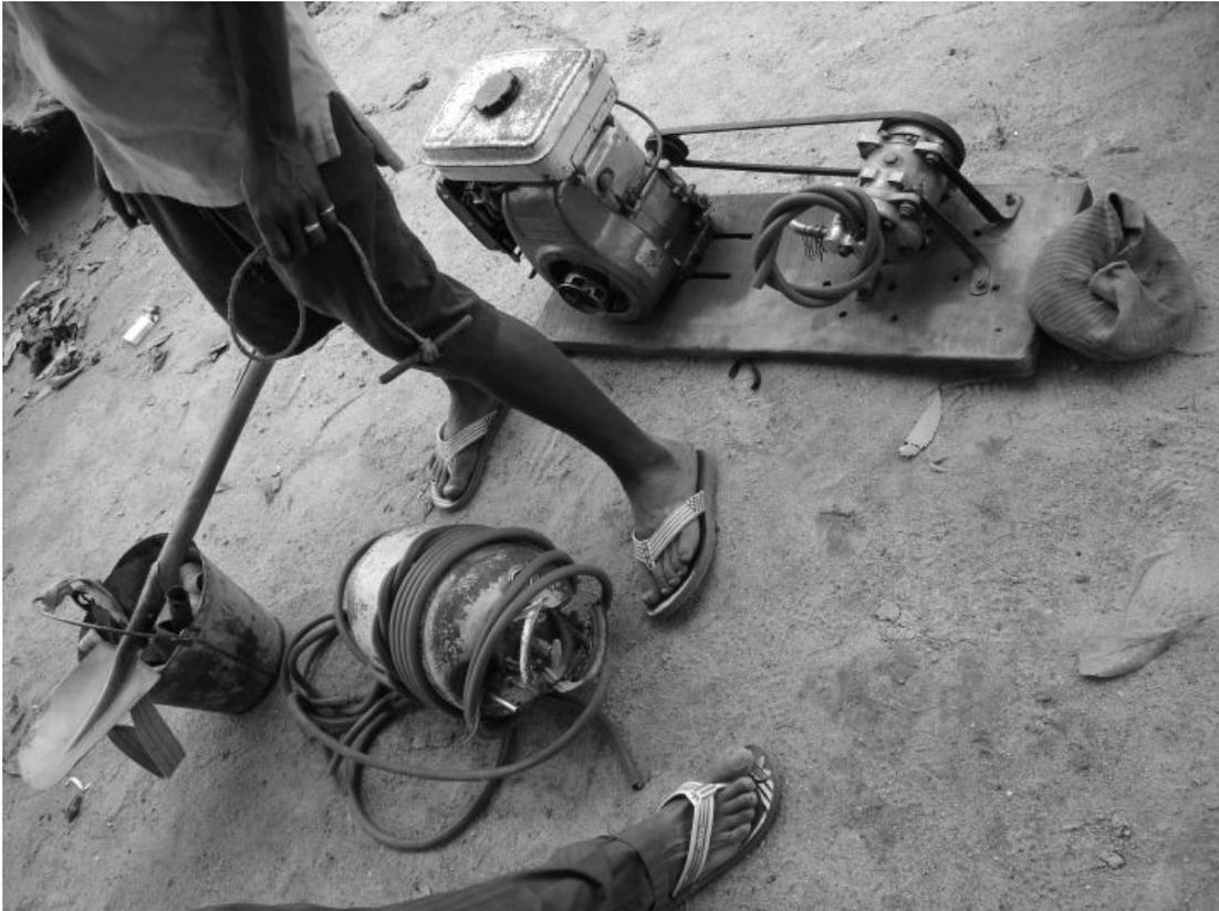
**Foto 3. Gli strumenti del *diving*. Da sinistra a destra si possono notare un secchio con una pala, una bombola dell'aria collegata ad un tubo di gomma e, più in alto, un compressore a gasolio da montare sulla canoa (Foto autore – Bo district, 2009).**
