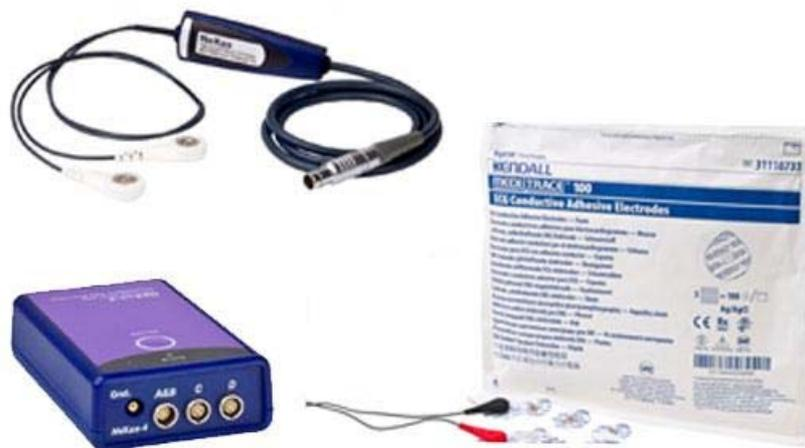
*Figura 2.6.4* NeXus-4 Equipment per la registrazione dell'attivazione del muscolo corrugatore del sopracciglio.
